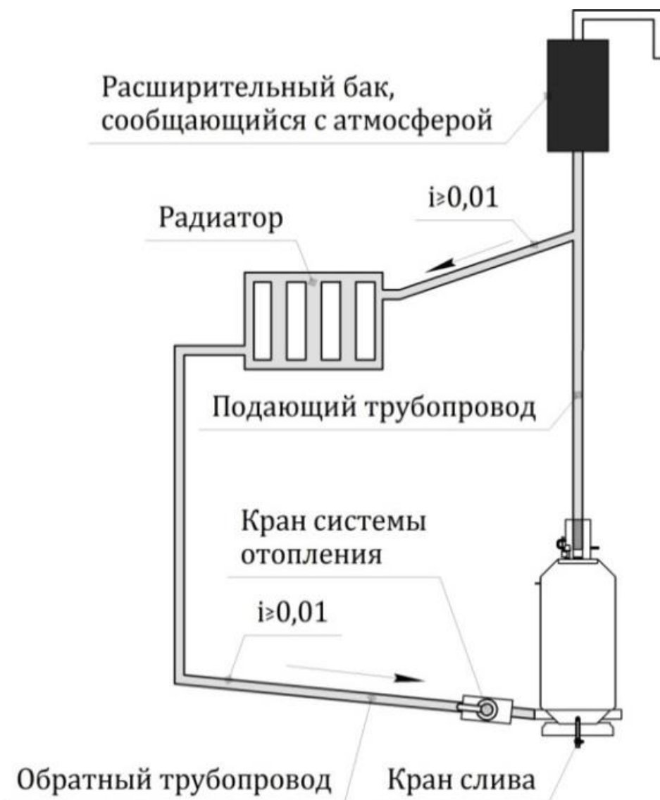
Рисунок 8 – Схема открытой системы отопления с естественной циркуляцией
